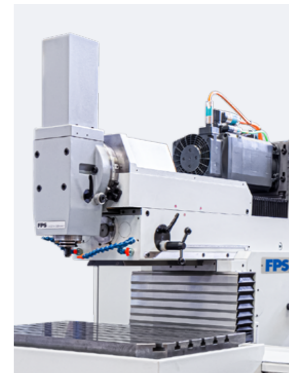
Konstante Frässtabilität bei komplett ausgefahrener Y-Achse durch das duale Führungssystem.
