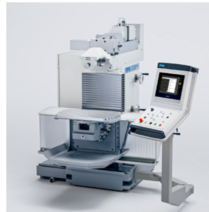
Optionen: Gegenhalter mit Gegenlager Schwenkbarer Umschlagstisch mit zugehöriger Spänewanne
